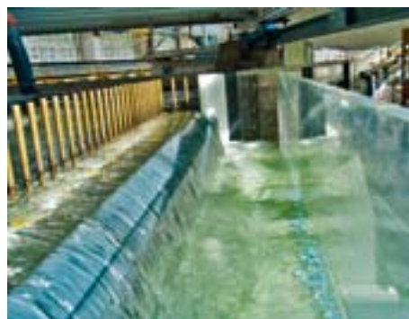
Das Wasser gelangt über einen Überfall in das Einlaufbauwerk.
