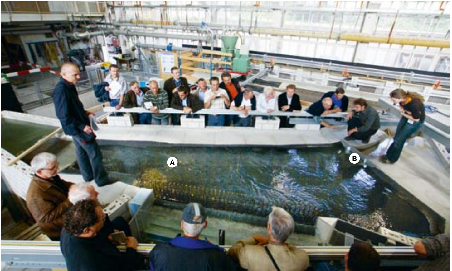
Ⓐ Im Teich werden das Geschiebe abgelagert, die Strömung beruhigt und mit dem Grobholzrechen das Schwemmgut vom Einlauf in den Stollen ferngehalten.
